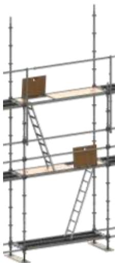
A) Garde-corps MDS au niveau du segment d'accès, monté depuis le niveau inférieur entièrement sécurisé de l'échafaudage (chapitre 8.3.7.1)
