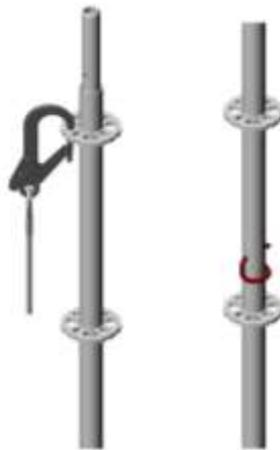
**Figure 8.11 :** Positions approuvées pour sécurisation sur les goujons (cerclées de rouge). Goujon situé au minimum à 1,0 m au-dessus du plancher de l'étage supérieur. Lorsque le montant est raccordé à un goujon au-dessus du plancher de l'étage supérieur, les montants doivent être sécurisés avec une broche de sécurité (voir figure de droite).
