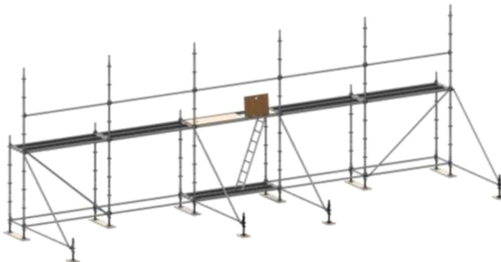
**Figure 8.9 :** Exemple de dispositif anti basculement temporaire.
