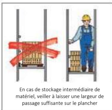
En cas de stockage intermédiaire de matériel, veiller à laisser une largeur de passage suffisante sur le plancher
