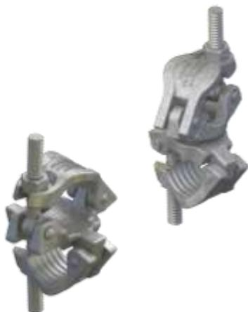
Les colliers sont utilisés pour relier deux tubes de l'échafaudage (de 48,3 mm de diamètre), par exemple le tube d'ancrage au montant vertical. Les colliers peuvent être droits ou orientables, tous deux avec une cale ou un boulon de fixation (conformément à la norme EN74).
