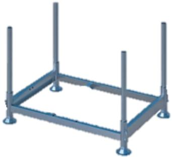
Gain de place lorsqu'il n'est pas utilisé car il est démontable. Se compose d'un cadre de base et de quatre tubes d'insertion. Conçu pour le chargement par chariot élévateur et le transport par grue. Empilables grâce aux grands pieds circulaires qui empêchent également toute pénétration dans un sol meuble et protègent la surface de contact. Charge utile 1500 kg.
