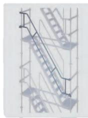
Main courante en acier pour escalier en aluminium de 2,00 m avec plateforme. Attachée à l'aide des semi-coupleurs intégrés aux tubes verticaux. Pour des longueurs de baie de 2,50m. La rampe extérieure est à positionner sur la face extérieure de la tour escalier.
