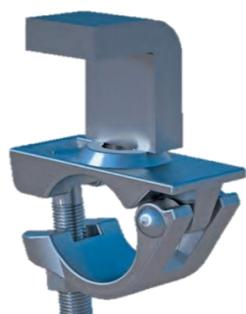
Demi-raccord avec équerre en acier soudée pour la fixation de tubes d'échafaudage ou de poutres en treillis sur des structures en acier ou des poutres. Utilisé souvent dans les plafonds ou les échafaudages suspendus. Hauteur d'angle 50 mm. Charge maximale admissible de 9 kN. Couple de serrage des écrous à embase 50 Nm.
