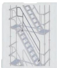
Pour un escalier de plateforme en aluminium, pour le raccordement de tubes ou pour la fixation en U. Cette rampe est à positionner dans la partie haute de l'escalier et à l'intérieur.
