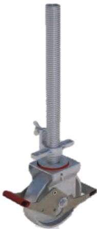
Pour tous types d'échafaudages mobiles, hauteur réglable pour alignement vertical. Avec frein de stationnement pour rester en sécurité et éviter de rouler par inadvertance. Peu d'effort lors du déplacement grâce au roulement à billes et une roue en nylon intégrés pour protéger l'empreinte. Avec pédale supplémentaire pour déverrouiller le frein de stationnement. Convient pour une utilisation extérieure et intérieure.
