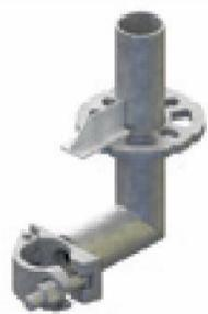
Est nécessaire avec le plancher d'angle variable pour s'adapter à la protection latérale en trois pièces. Connexion du support à n'importe quel angle avec le coupleur d'échafaudage. Également utilisée pour relier des modules d'échafaudage individuels ou des montants montés parallèlement les uns aux autres.
