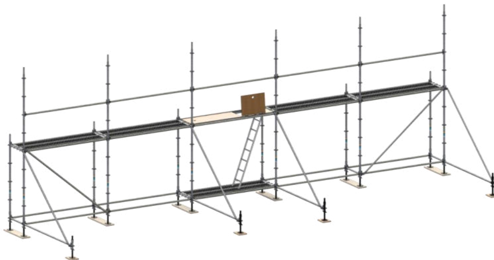
Figure 8.9 : Exemple de dispositif anti basculement temporaire.
