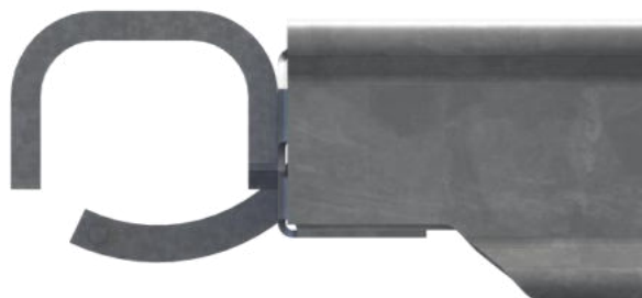
Figure 5.2 : Dispositif anti-soulèvement sur le plancher en acier
