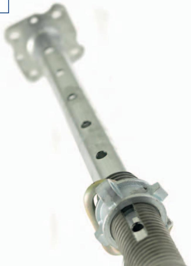
L'étau à vis AN est un étau de robustesse moyenne. Les étais de type AN sont pourvus d'un filetage extérieur pour le réglage en finesse et de platines de tête et de pied pour une utilisation en combinaison avec un système de coffrage ou des supports en bois. L'étau AN peut être monté dans deux directions : avec le tube intérieur en haut ou en bas.
