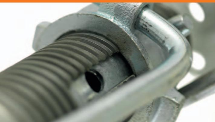
Les étais de robustesse moyenne du type EP20 conviennent pour le soutènement d'une charge minimale de 20 kN quelle que soit la hauteur de l'étais déployé, de 1 500 à 5 500 mm. Les étais sont pourvus d'un filetage extérieur pour le réglage en finesse et de platines de tête et de pied pour une utilisation en combinaison avec un système de coffrage ou des fourches. Les étais EP20 peuvent être montés dans deux directions : avec le tube intérieur vers le haut ou vers le bas.
