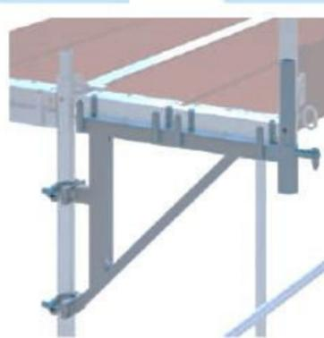
Acier galvanisé à chaud avec demi-collier soudé. Pour l'élargissement de l'échafaudage de 0,65 m à l'intérieur ou extérieur de l'échafaudage ainsi que pour la prolongation de parties frontales. Pour le rehaussement de l'échafaudage sur consoles de débordement.
