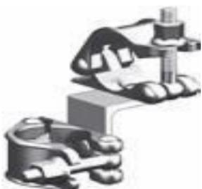
Convient pour la connexion à angle droit des poutres en treillis et des tubes verticaux. Couple de serrage des écrous à embase 50 Nm.
