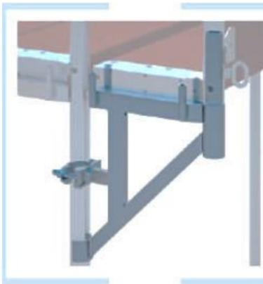
Acier galvanisé à chaud avec demi-collier soudé. Pour l'élargissement de l'échafaudage de 0,30 m et le montage de montant de garde-corps.
