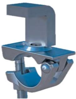
Demi-raccord avec équerre en acier soudée pour la fixation de tubes d'échafaudage ou de poutres treillis sur des structures en acier ou des poutres. Utilisé souvent pour les échafaudages suspendus. Hauteur d'angle 50 mm. Charge maximale admissible de 9 kN. Couple de serrage des écrous à embase 50 Nm.
