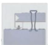
Fil d'acier stable, galvanisé à chaud, pour empêcher les planches maçons en acier de se soulever.
