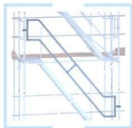
Pièce faite en acier, pour les escaliers en aluminium de 2,00 m avec plateforme. Fixée au support d'escalier à l'aide du support de serrage avec raccord vissé. La rampe extérieure est à positionner sur la face intérieure de la tour escalier.
